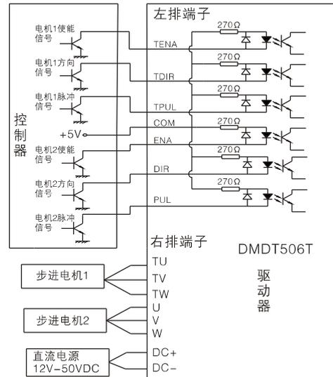
图5. 3HB606x2 驱动器接线
