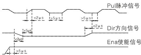
图4. 输入信号波形
