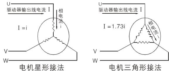
图2. 电机接线
