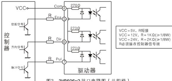
图3. 3HB606x2 接口电路图 (共阳极)
