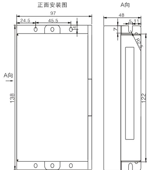
图1. 3HB606x2 机械尺寸图 单位：毫米
